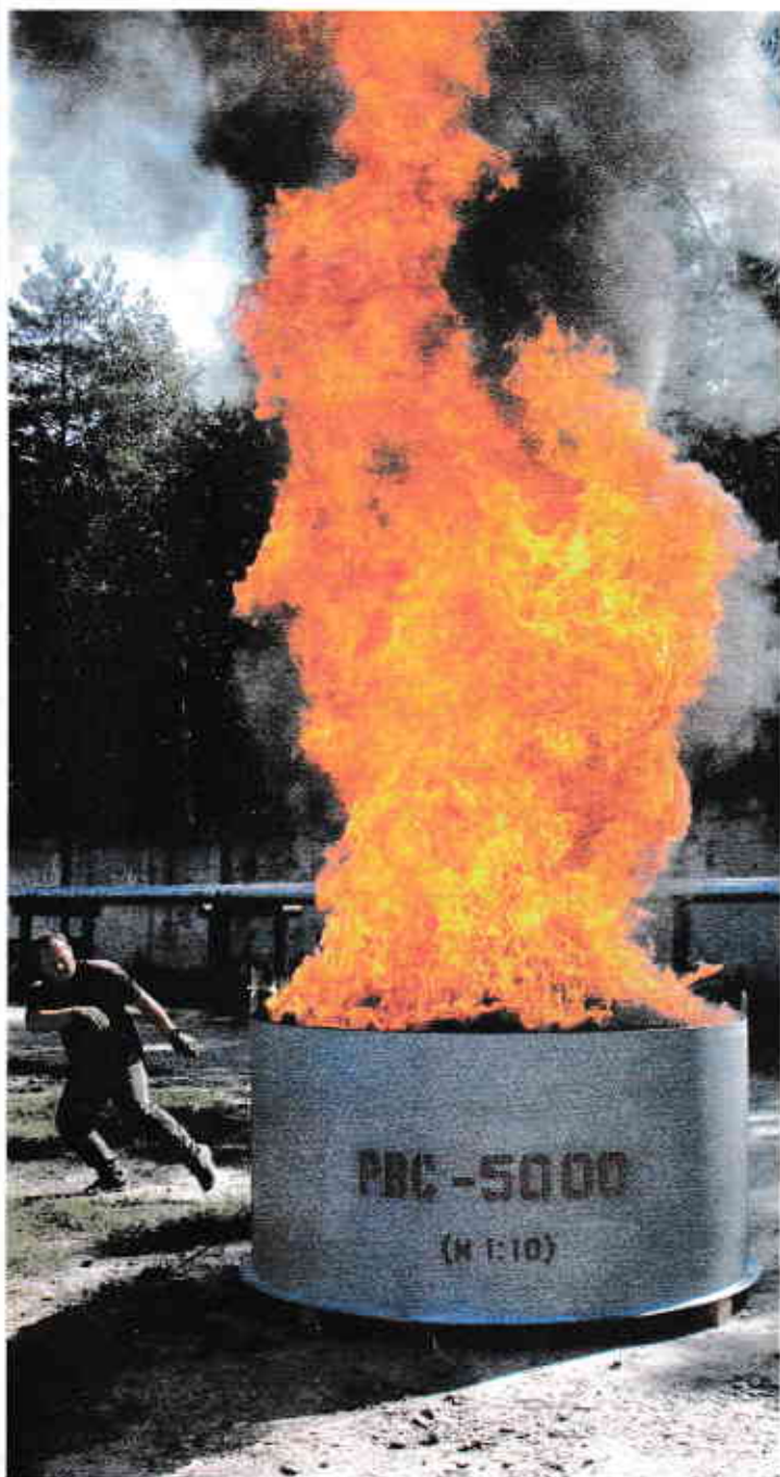
1. Процесс горения нефтепродукта в резервуаре без применения тушащего материала (через 13 сек. после поджога).
