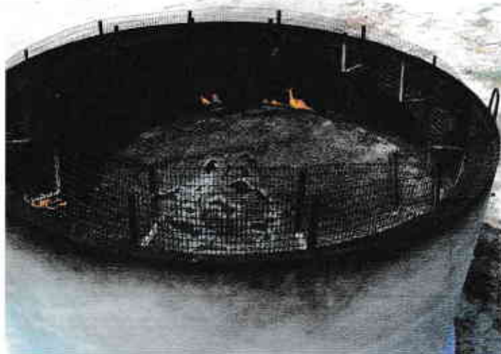
3. Состояние поверхности через 8 минут после поджога нефтепродукта в резервуаре с пакетированным тушащим материалом.
